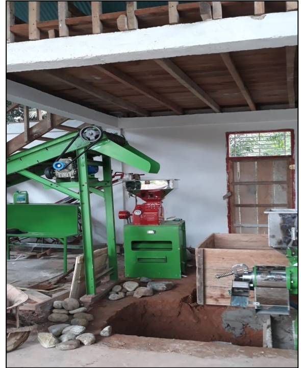
Tim melakukan pemeriksaan dan Uji coba Rice Milling Unit (RMU)
