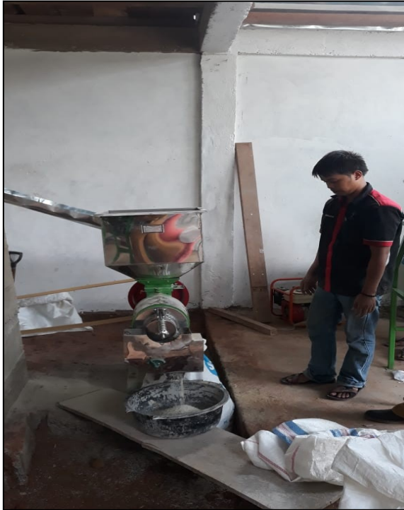
Tim melakukan pemeriksaan dan Uji coba Rice Milling Unit (RMU)
