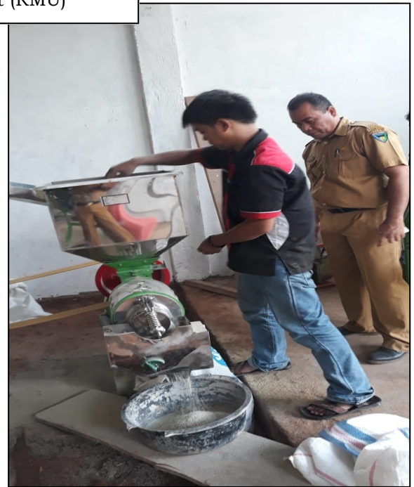
Tim melakukan pemeriksaan dan Uji coba Rice Milling Unit (RMU)
